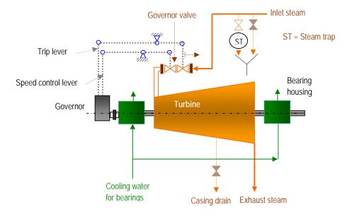
PIPING DIAGRAM AROUND SINGLE STAGE BACK PRESSURE STEAM TURBINE TYPICAL
