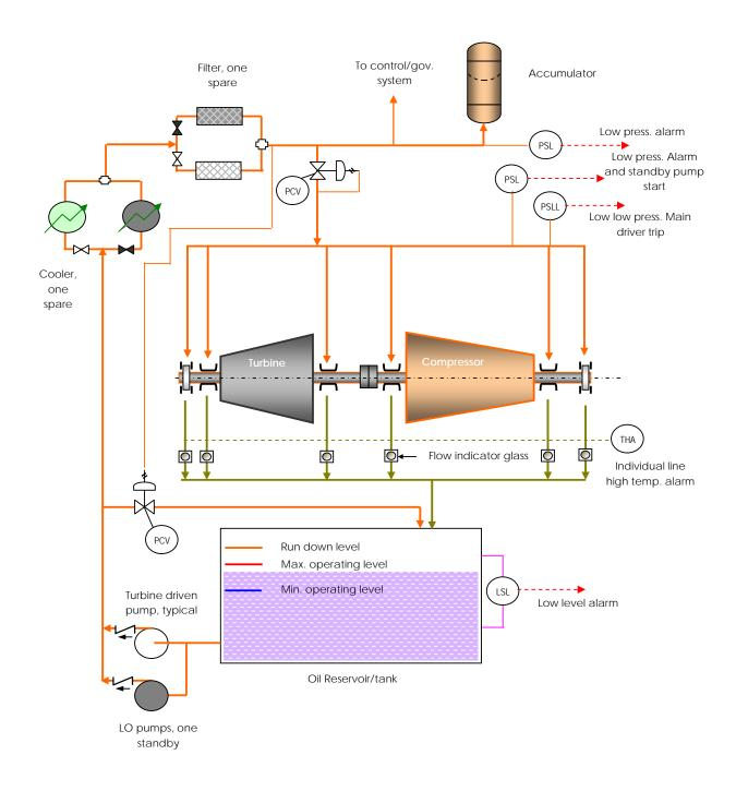
SIMPLIFIED OIL SYSTEM FOR STEAM TURBINE TYPICAL, COMMON OIL SYSTEM
